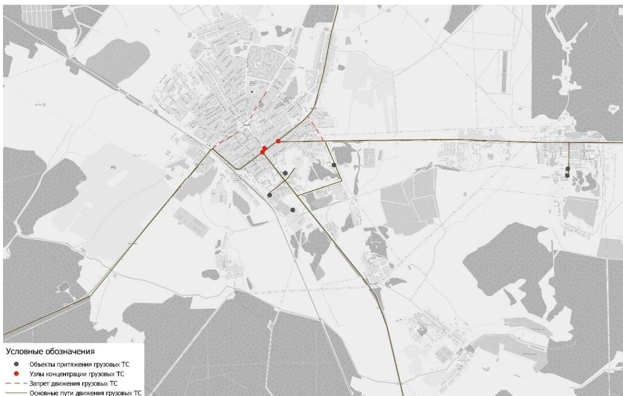
Рисунок 1.8.1 – Схема движения грузового транспорта на территории Талдомского г.о.
